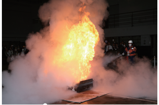
写真6 粉末消火器による液体燃料火災の消火実験
